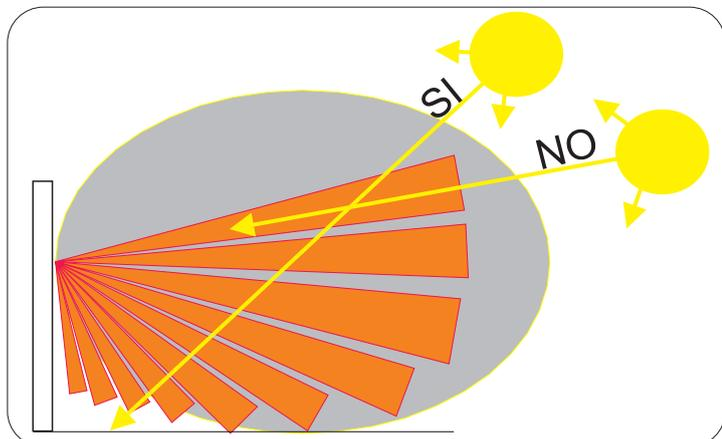
Per protezioni di pareti, evitare che una zona sensibile dell'Infrarosso si trovi a contatto con il muro per non annullare il beneficio del sensore infrarosso a doppio elemento.
