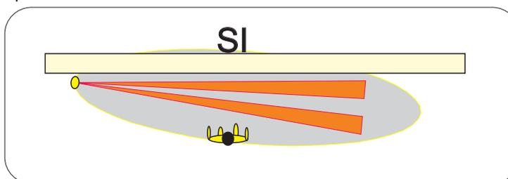
Prediligere installazioni ove ci sia un muro / pavimento a delimitare il campo di rilevazione del sensore. Non puntare quindi il sensore nel vuoto
